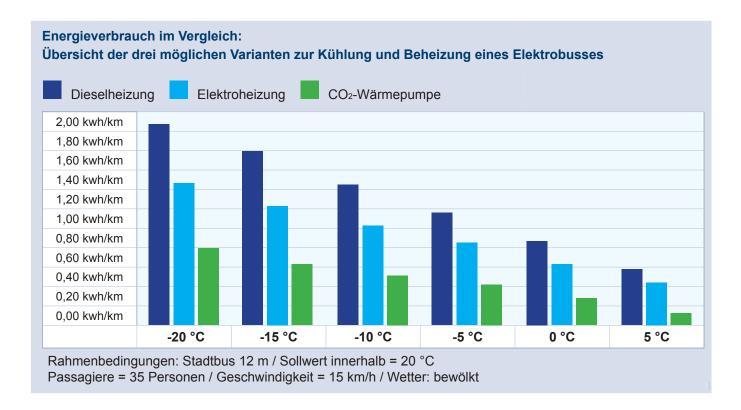
Der Energieverbrauch im Vergleich zeigt auf, dass von den möglichen Varianten der Klimatisierung eines Elektrobusses die CO<sub>2</sub>-Wärmepumpe am energiesparendsten ist.
